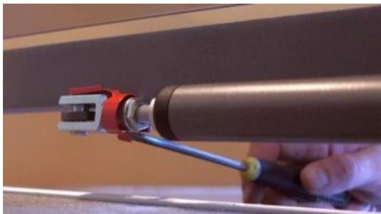
1. Retire la rosca del eje de fijación con una herramienta adecuada: destornillador, regla, abrebotellas o similar.
